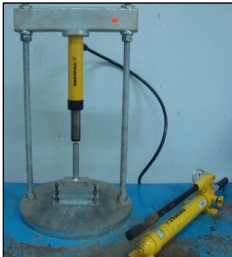
Rajah 8: Alat tekanan mampatan hidraulik
