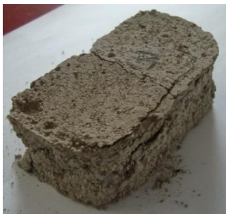
Rajah 12: Bentuk kegagalan prototaip CSEB yang berasaskan tanah liat
