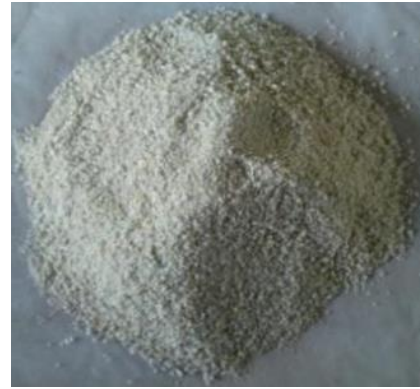
Rajah 4: Pasir melepasi ayakan 2mm
